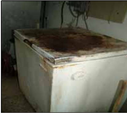
FREEZER CON CORROSIÓN
